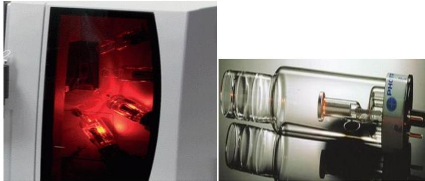
**Figure 5** : Photo d'une LCC placée dans un SAAFG(247)
