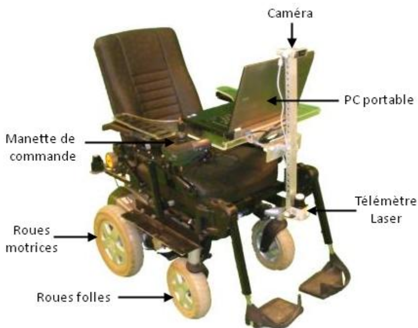
Figure 2.2: Fauteuil VAHM 3 instrumenté (100cmx70cm).
