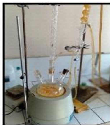
Photo 5 : Dispositif d'extraction par simple hydrodistillation
