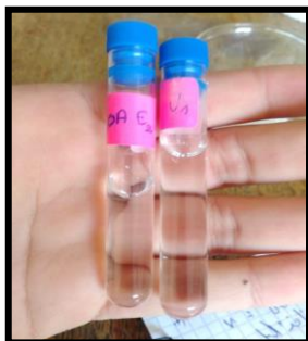
Photo 6 : Huile essentielle obtenue par hydrodistillation (simple et avec un appareil de type Clevenger, respectivement)
