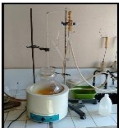
Photo 4 : Dispositif d'extraction par hydrodistillation avec un appareil de type Clevenger
