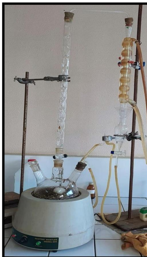
**Photo 4 : Dispositif d'extraction des huiles essentielles par simple hydrodistillation**
