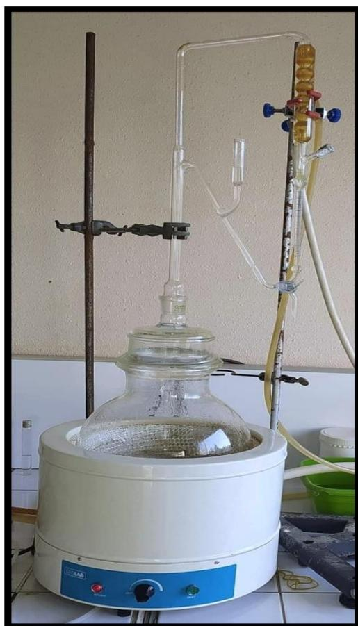
**Photo 3 : Dispositif d'extraction des huiles essentielles par hydrodistillation avec un appareil de type Clevenger**
