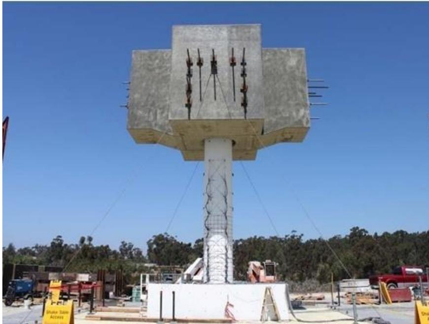
**Figure 4.3 : Échantillon d'essai : semelle, colonne, superstructure**
