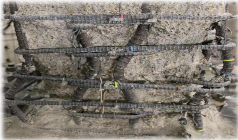
**Figure 1.31 : Flambement des barres longitudinales. [4]**
