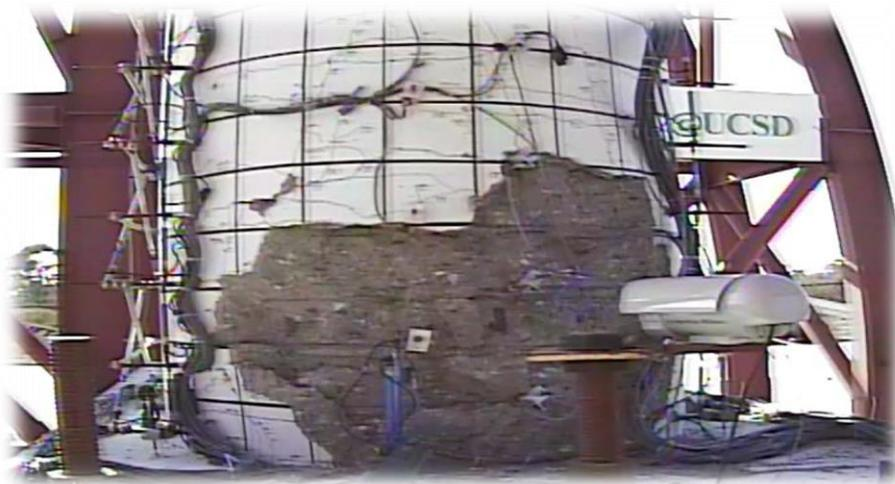
Figure 1.29: Eclatement de béton dans la zone de recouvrement. [5]
