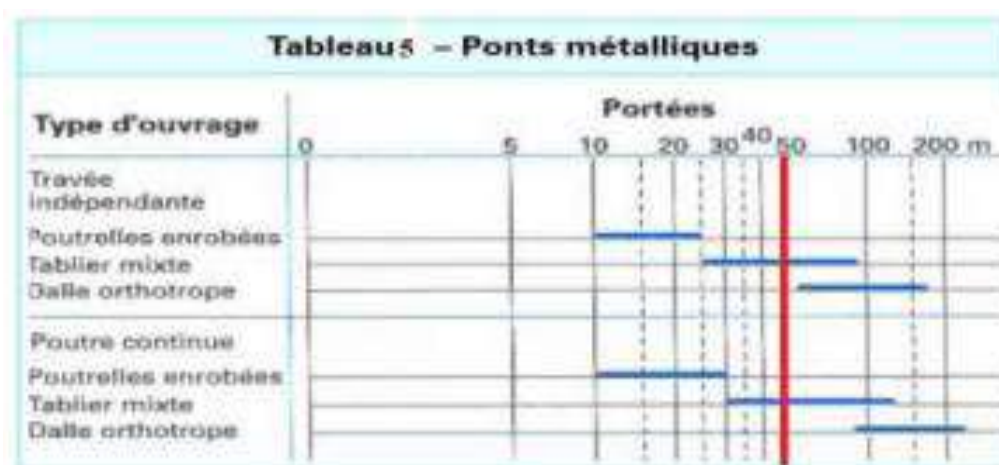
Figure 1.1 : types d'ouvrages en fonction de la portée [1]
