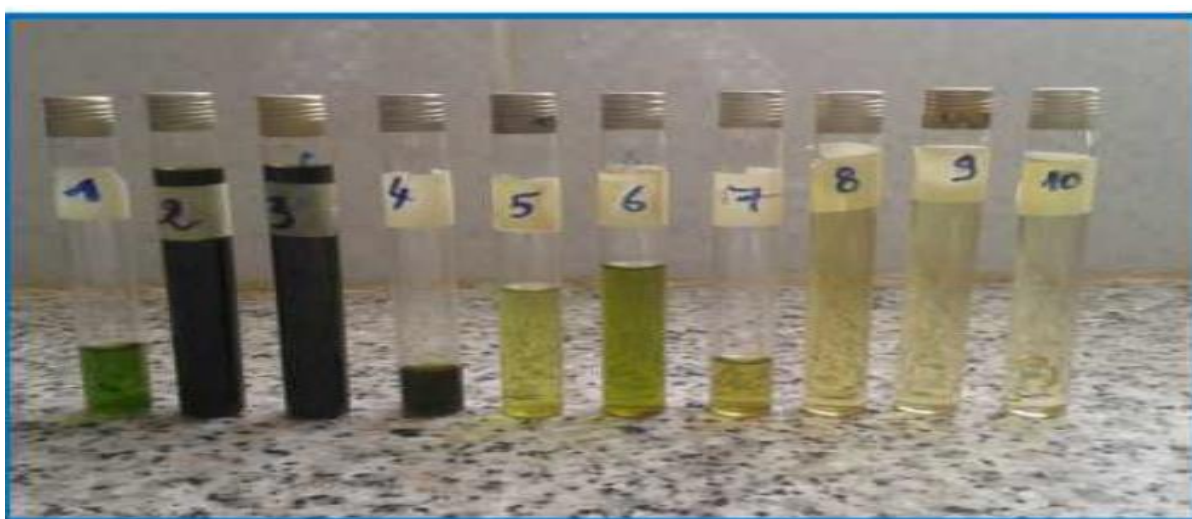
Figure n°28 : Les différentes fractions obtenues par chromatographie sur colonne de l'extrait éthanolique de Warionia saharae .
