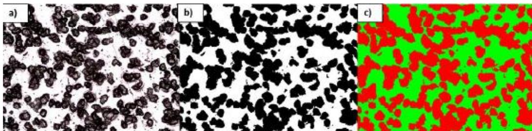
**Fig.3. 8** Surface acier 35NCD16 traitée par grenailage partiel à 8A. a) Micrographie initiale. b) micrographie traitée. c) Détermination du degré de couverture par métallographie quantitative (%GC=52,34 %)
