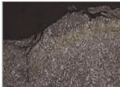
**Fig.1. 10** Dommages causés par une couverture excessive à la surface du matériau
