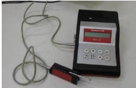
**Fig.2. 9** Testeur de rugosité DIAVITE DH-6
