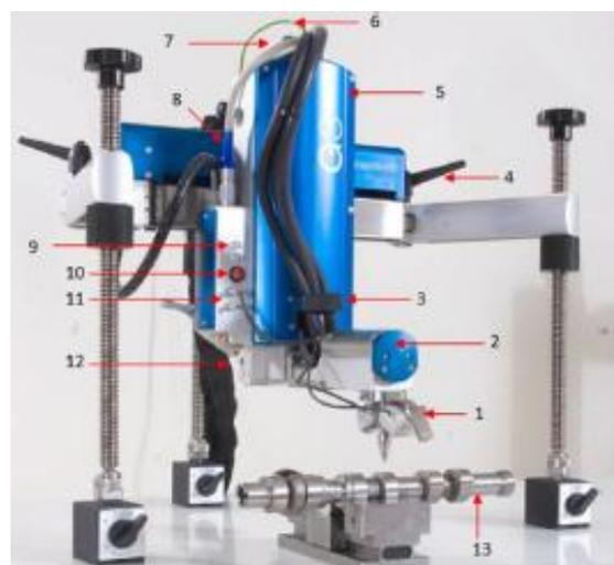
**Fig.2. 17** Système d'irradiation et de mouvement (goniomètre)
