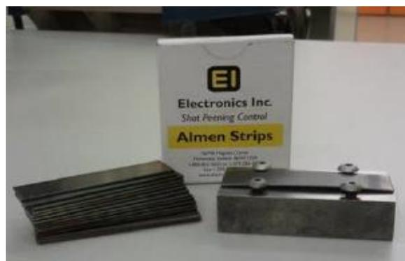
**Fig.2. 6** Fixation des spécimens Almen au bloc Almen
