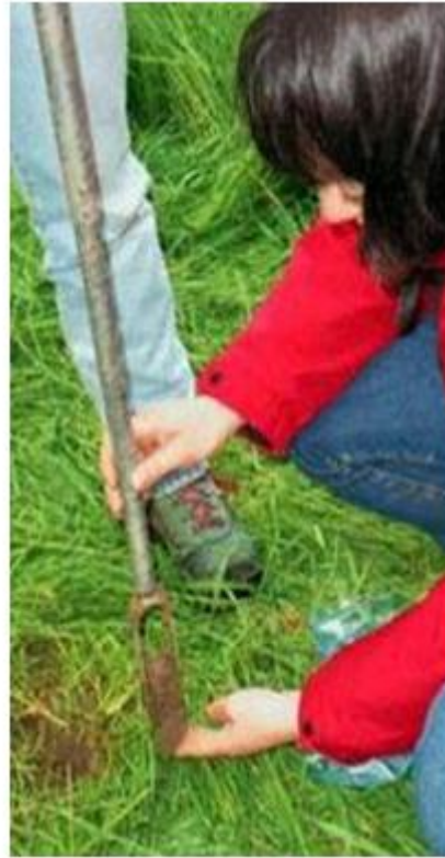
Photo 2.4 : Tarière manuelle pour prise d'échantillon.
