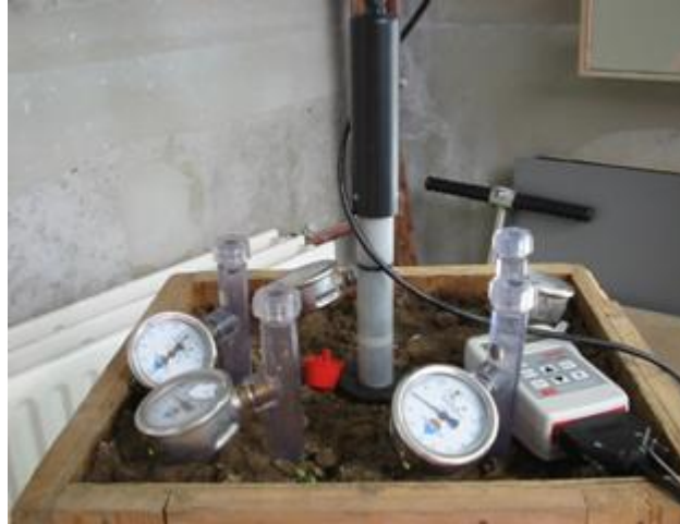
Photo 4.1 : Placement des appareillages sur caisson de laboratoire
