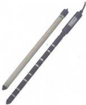
Photo 3.2 : La sonde PR1 de Delta-TDevices.
