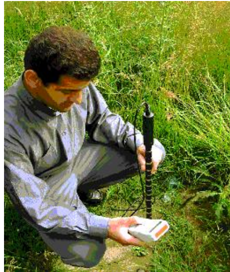
Photo 3.3 : Manipulation de la sonde PR1 de Delta-TDevices.
