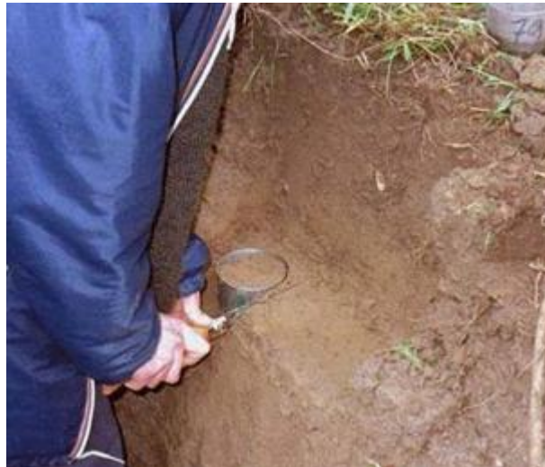
Photo 2.5 : Cylindre pour la détermination de la masse volumique apparente d'un sol.
