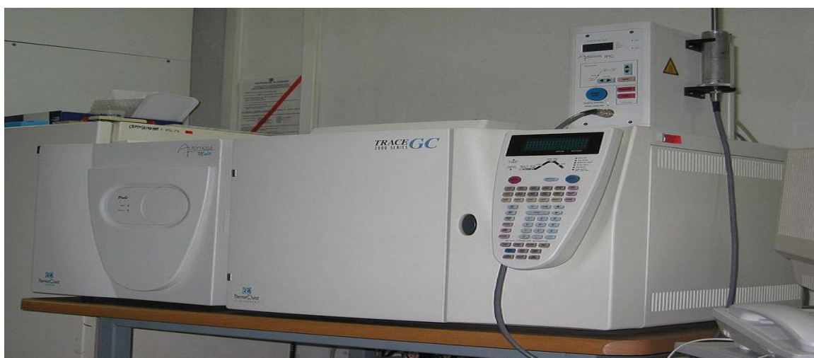
Figure 13 : Exemple d'un appareil CPG-SM
