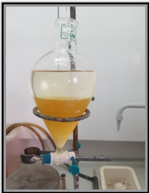
**Figure 63** : photo prise lors de l'extraction liquide-liquide.
