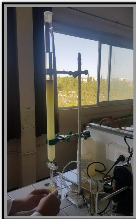
**Figure 65** : photo prise l'ors de la chromatographie sur colonne.
