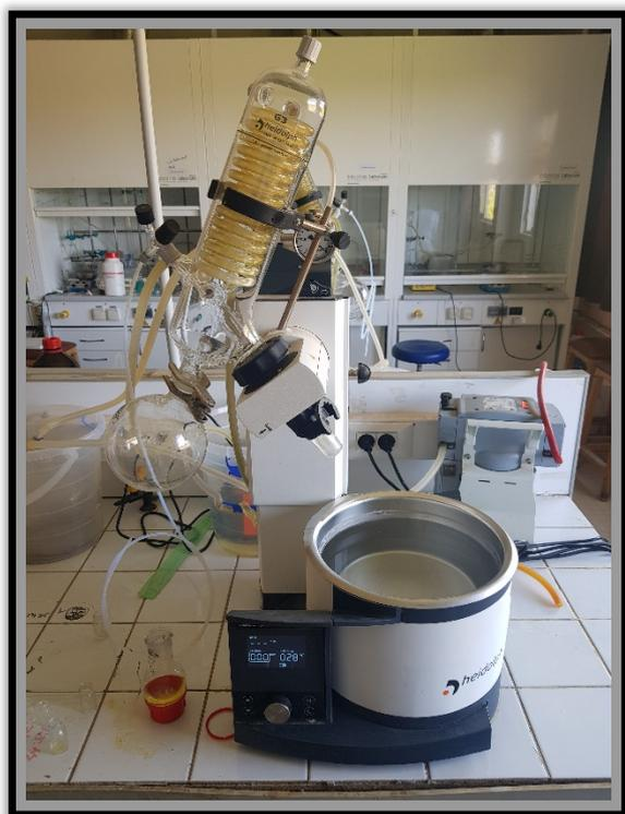
**Figure 57 :** Evaporateur rotatif utilisé.
