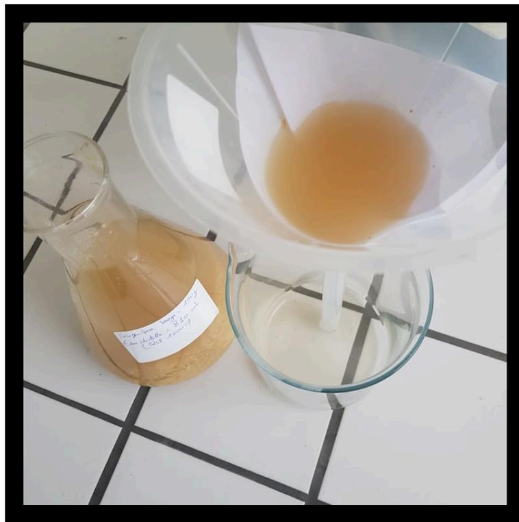
**Figure 53 :** Filtration à l'aide du filtre de wattman.
