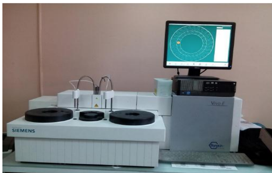
Figure 20 : analyseur viva E (SIEMENS) au niveau de l'unité de toxicologie
