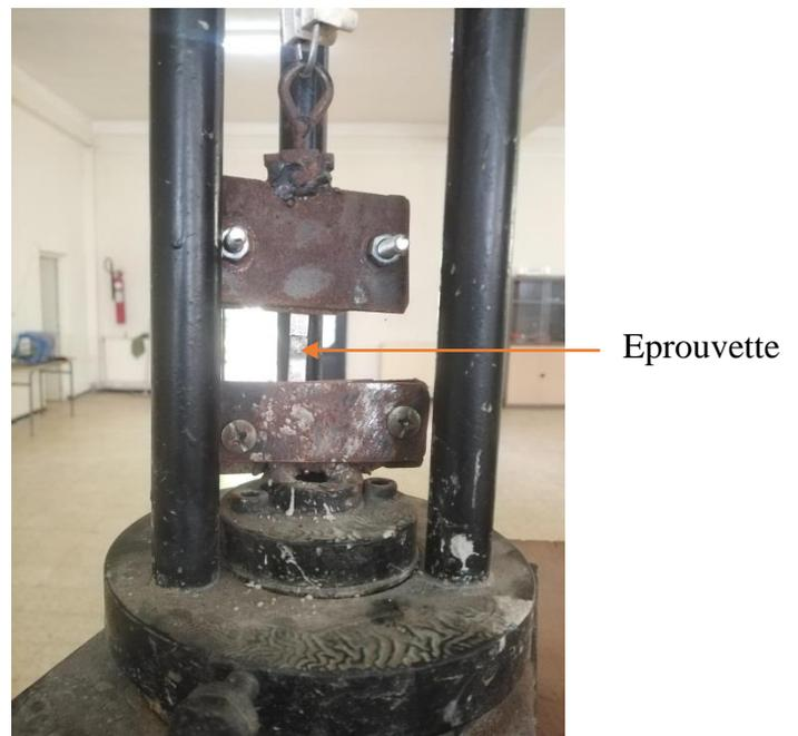
**Figure 3.9** : machine de traction
