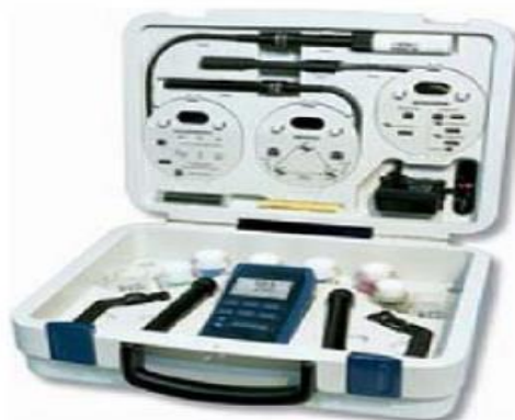
Figure IV 11 : Malette pour la mesure des paramètres physicochimiques WTW de type Multi 340i/SET N°:2F30-114B22.
