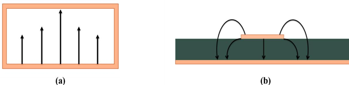
**Figure II.5.** Lignes de champs dans (a) un guide d'ondes rectangulaire, (b) une ligne microruban.
