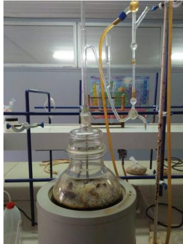
Figure 30. Dispositif de l'extraction des huiles essentielles de type Clevenger.
