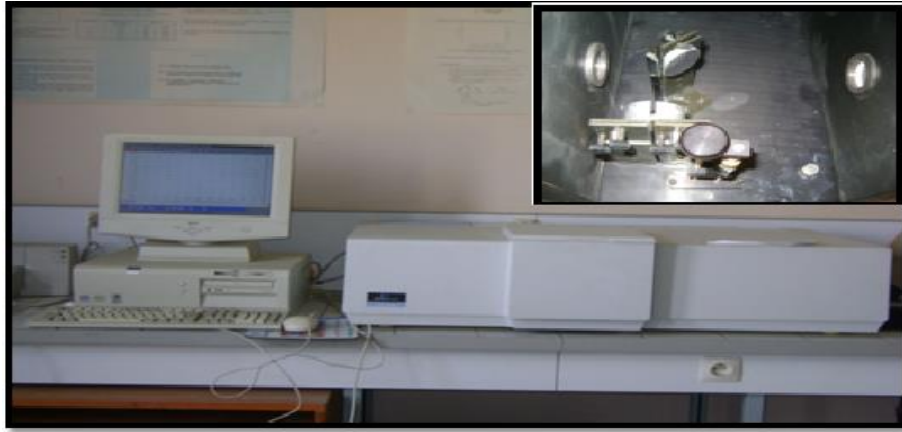
Figure II.9 : Appareil de l'Ultraviolet-visible Perkin-Elmer Lambda 800 avec le système utilisant la réflexion diffuse.
