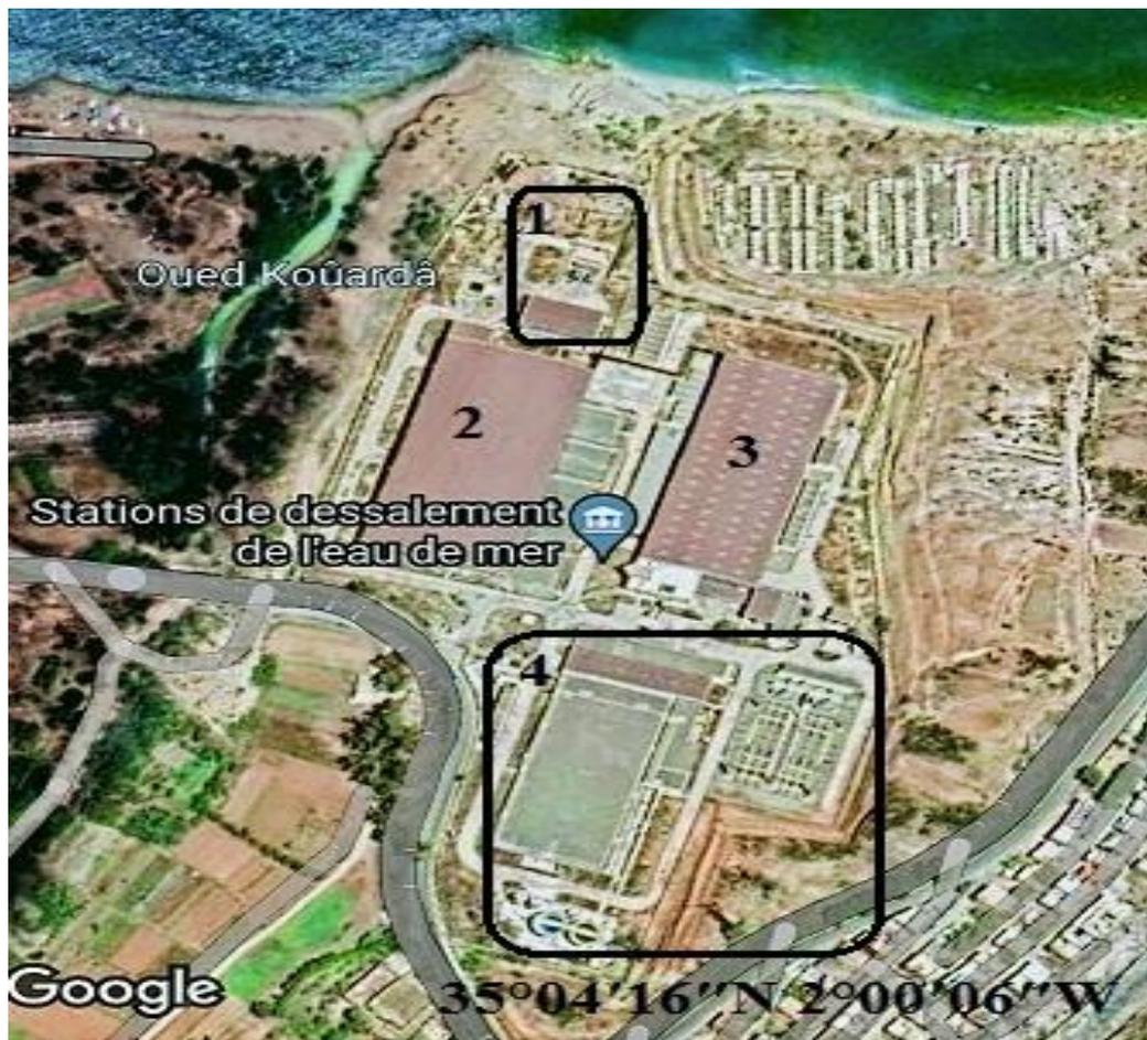
**Figure N° 4** : Vue satellitaire de la station de dessalement d'eau de mer de Souk Tlata. Les chiffres désignent les différentes unités de la station. 1 : Prise d'eau de mer, 2 : Ultrafiltration, 3 : Osmose inverse et 4 : Post-traitement.
