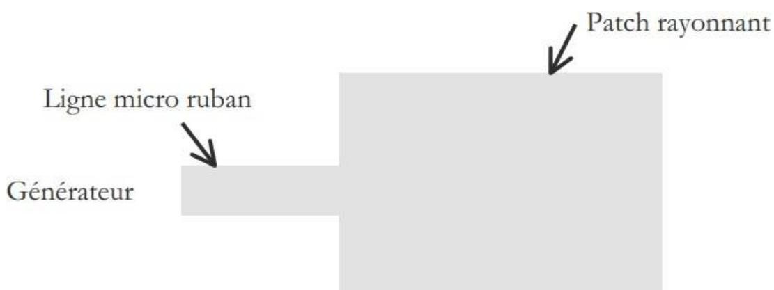
Figure 1.11 Alimentation par ligne micro ruban
