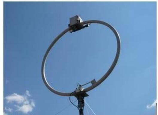
Figure 1.2 boucle magnétique
