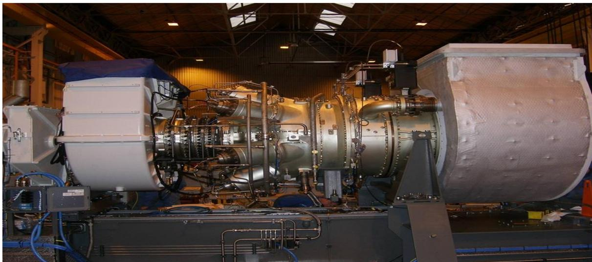
**Fig. II-1. Turbine à gaz SGT-400 [8].**
