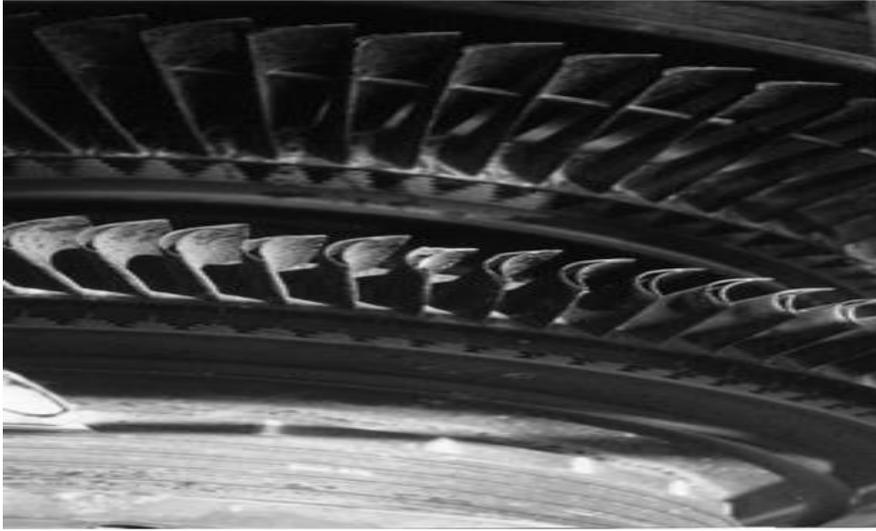
**Fig. I-11. Turbine à gaz 1970 conçue avec laçage fil pour amortir les secondes aubes de la turbine [7].**
