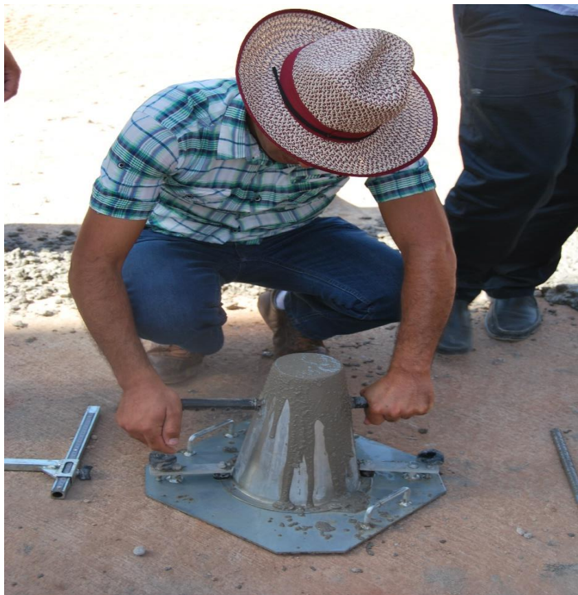
Contrôle de l'affaissement de béton (Cône d'Abrams) Slumptest
