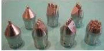
**Fig.II.9** : Exemple d'indenteurs interchangeables proposés pour l'UltraPeen [132].
