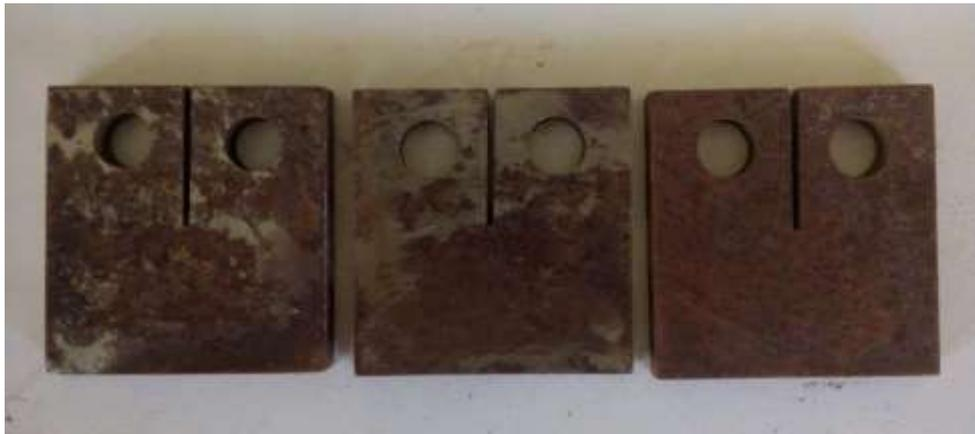
**Fig.III.18 :** Eprouvettes CT après opération de chauffage
