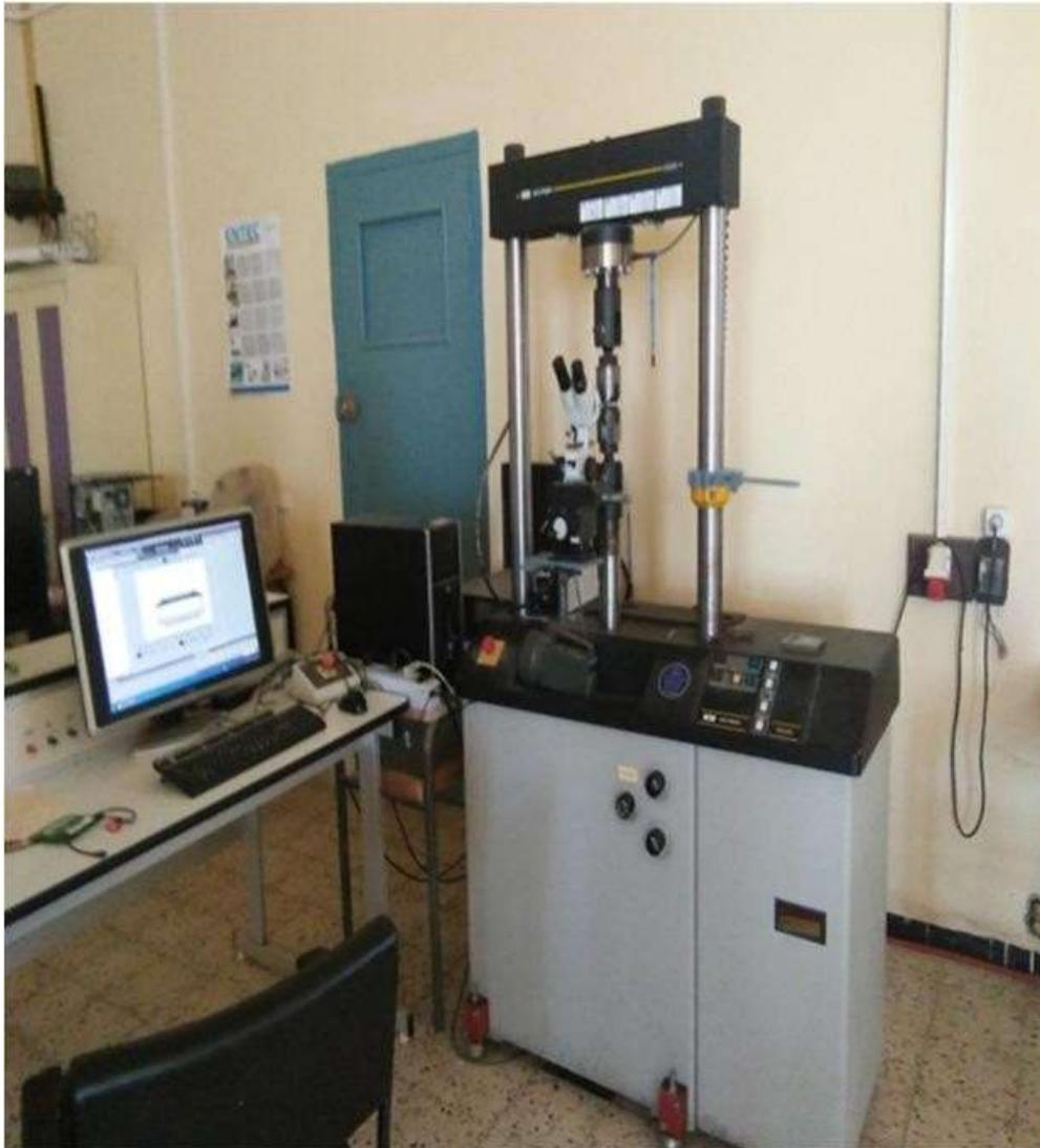
**Fig III.9** : Machine électro-hydraulique asservie INSTRON
