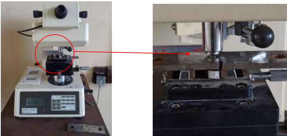
**Fig.III.5 :** Présentation du micro-duromètre SHIMADZU HMV-2000
