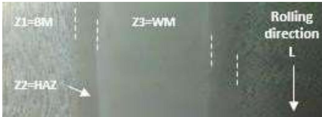
**Fig. III.2 :** Orientation des coupes polies pour les examens micrographiques
