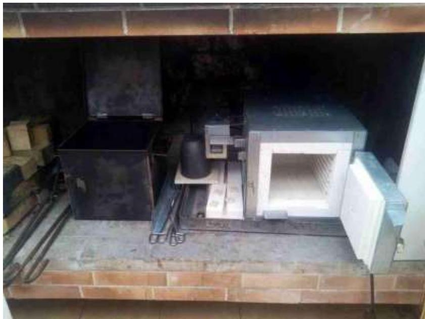
**Fig.III.17** : Modèle de four utilisé pour le traitement de recuit
