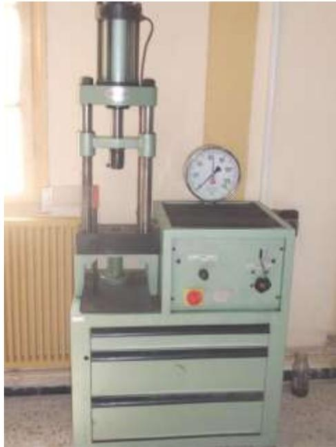
**Fig.III.14** : Photo de la machine de compression
