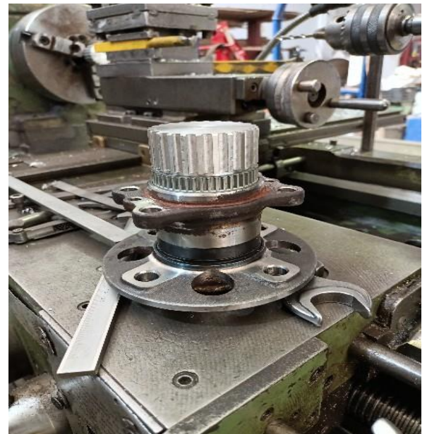
Figure IV. 8: moyeu après fixation de pignon
