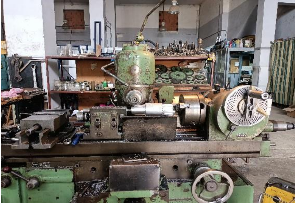
Figure IV. 2: Réalisation des dentures des pignons
