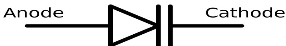
Figure II-10 : Diode varicap.
