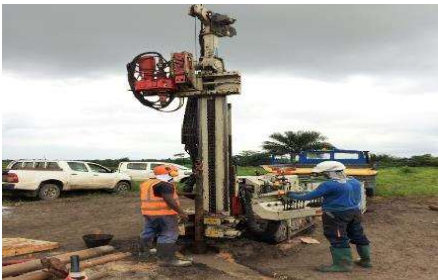
Figure 2.1 : Essai pressiométrique type MENARD
