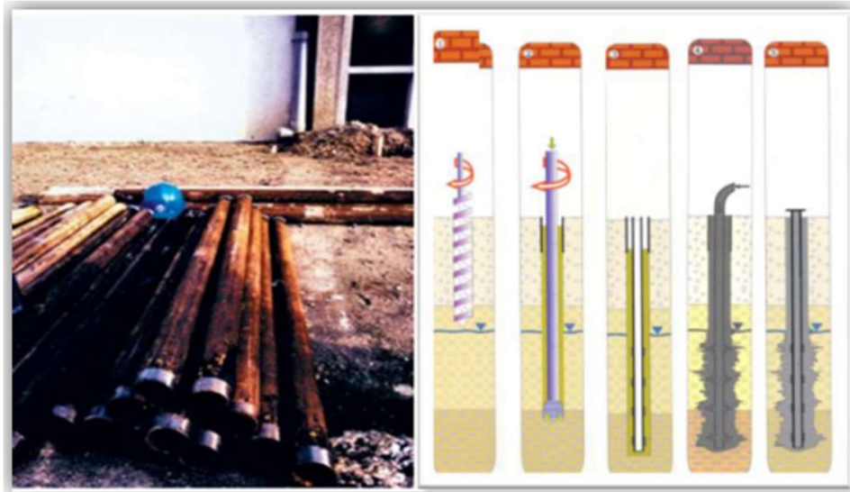
Figure 1.11 : Schéma représentant un exemple de micro pieu
