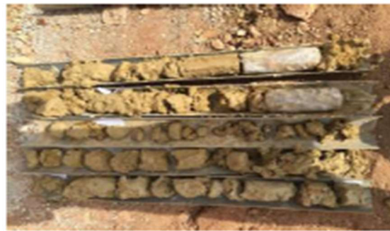
Photo 3.9 : Grès, semi roche semi meuble
