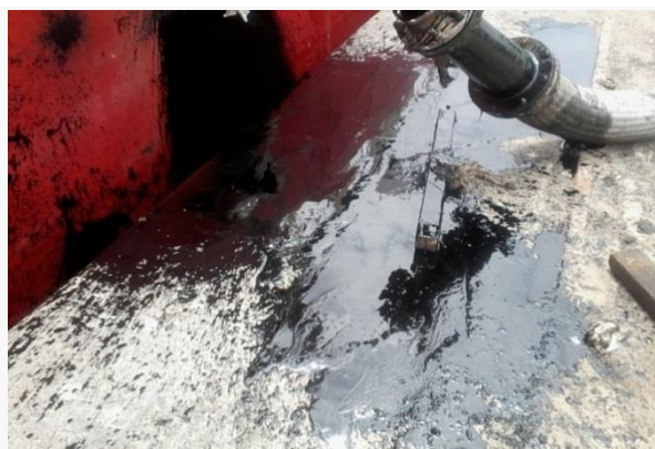
Figure III. 11 : Fuite de bitume.
