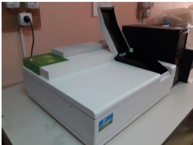
**Figure 19 : Spectrophotomètre UV-visibles**
