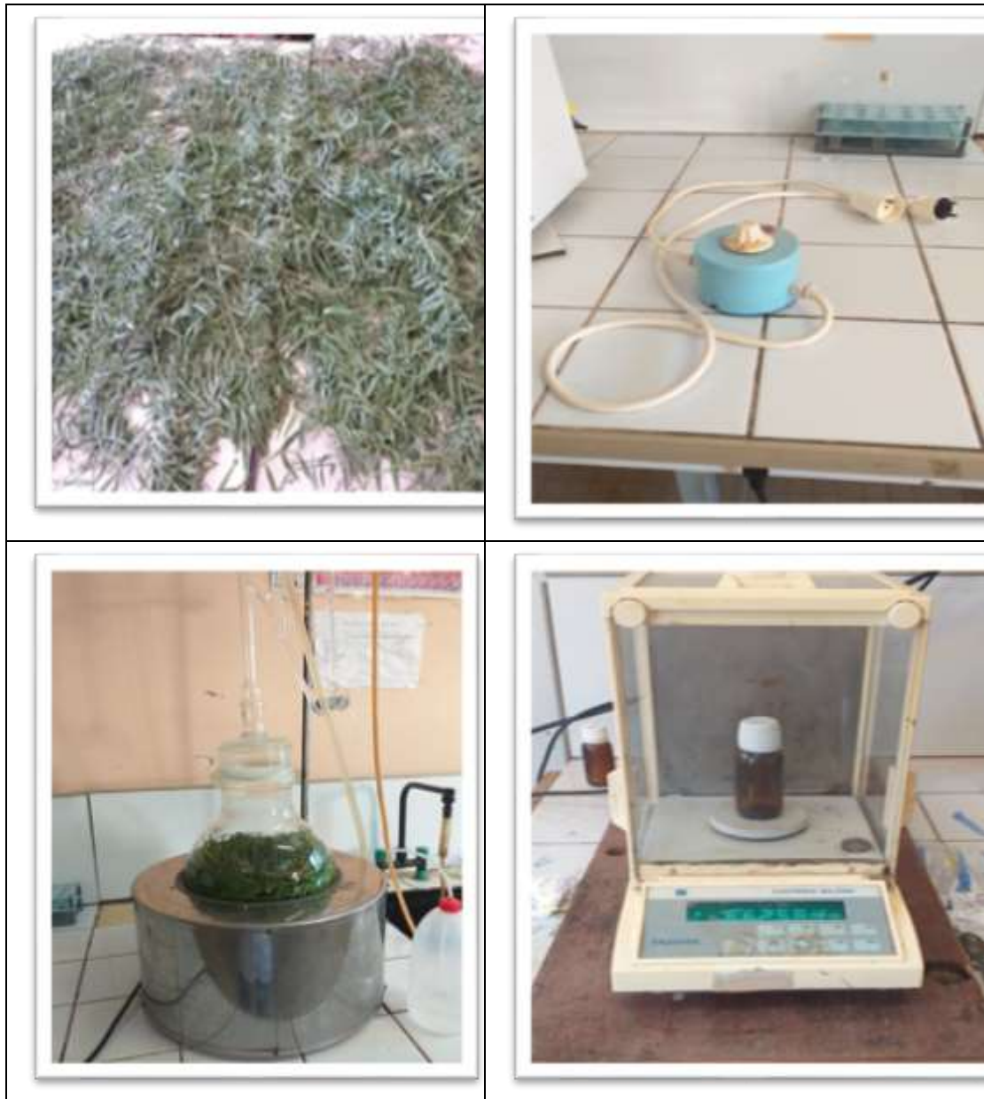
Figure N° 14 : Méthode Extraction des huiles essentielles : Hydrodistillateur de type Clevenger (Antar 2022)
