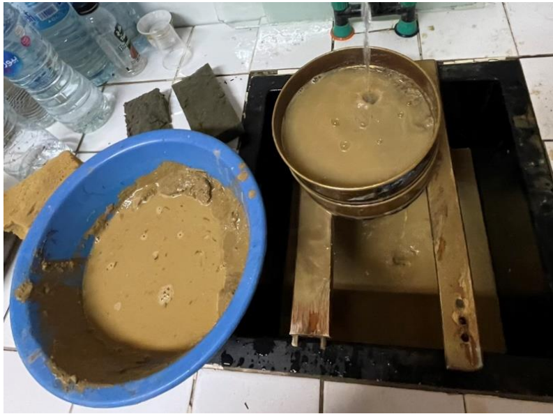
Fig. 2. Lavage et tamisage du sédiment.
