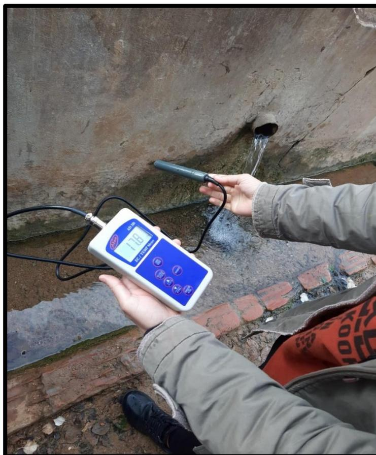
**Photo N° 03 : Conductimètre.**
