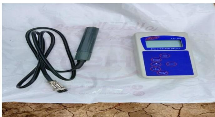
Figure IV.02 : Conductimètre.
