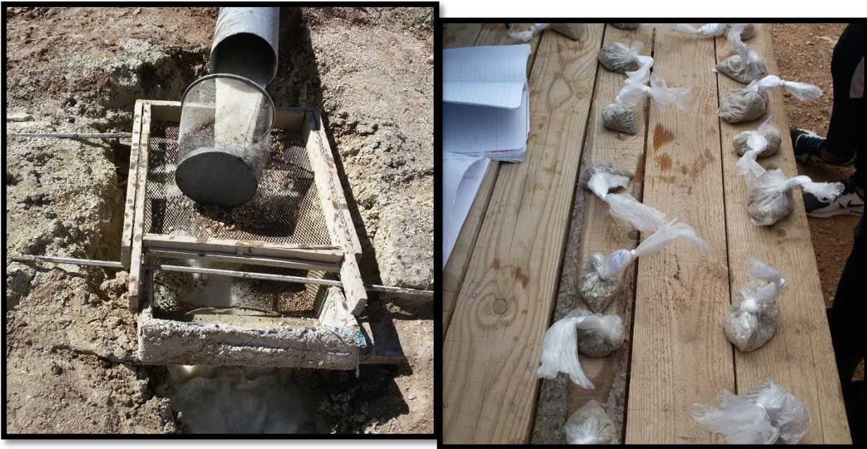
Figure 9: Tamis de récupération et échantillons de cuttings du forage (photo prise par Bouderra et al 2018)
