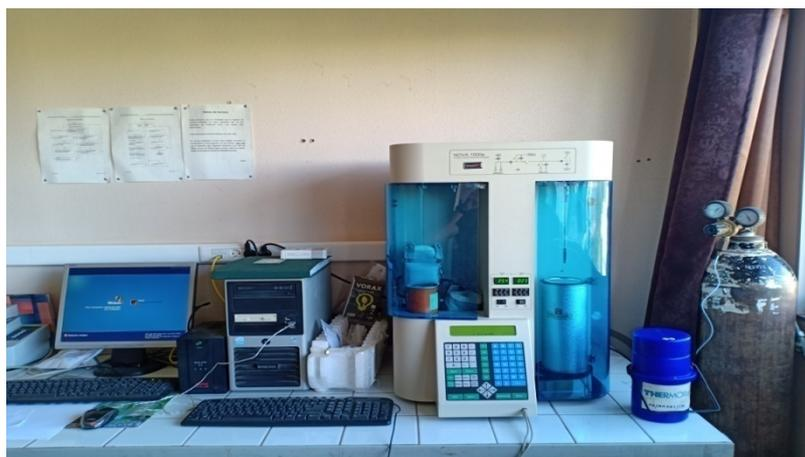
**Figure 7** : Appareil NOVA 1000e employé pour les mesures d'adsorption/désorption d'azote
