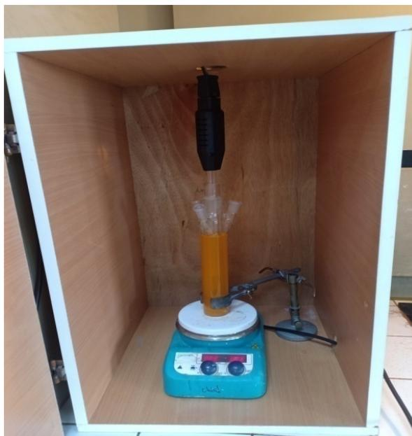
**Figure 11.** Photoreacteur utilisé dans la photodégradation du MO
