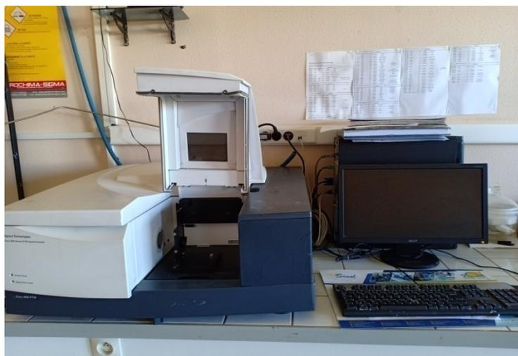
**Figure 6** : Spectromètre Infrarouge à Transformée de Fourier (FTIR)
