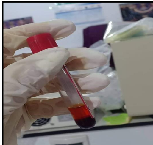
Photo n°19 : un tube centrifugé pendant 20 minutes à 2500 tours/min (labo de recherche BIOMOLIM-Tlemcen)
