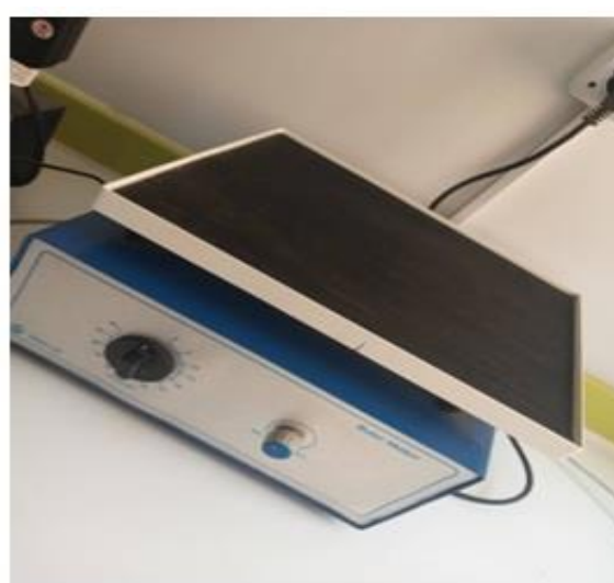
6/- Rotateur mécanique avec une Vitesse ajustable (80-100 t.p.m)
