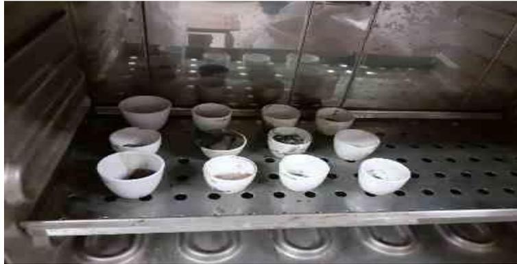
**Figure17** : Séchage des échantillons à l'étuve (photo originale)
