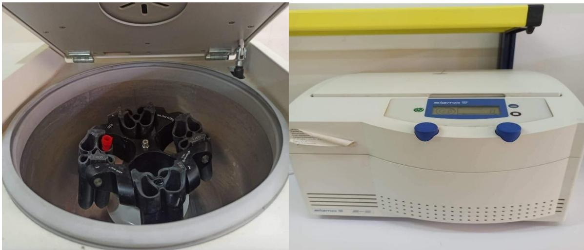
**Figure 11 :** centrifugeuse (photo originale)
