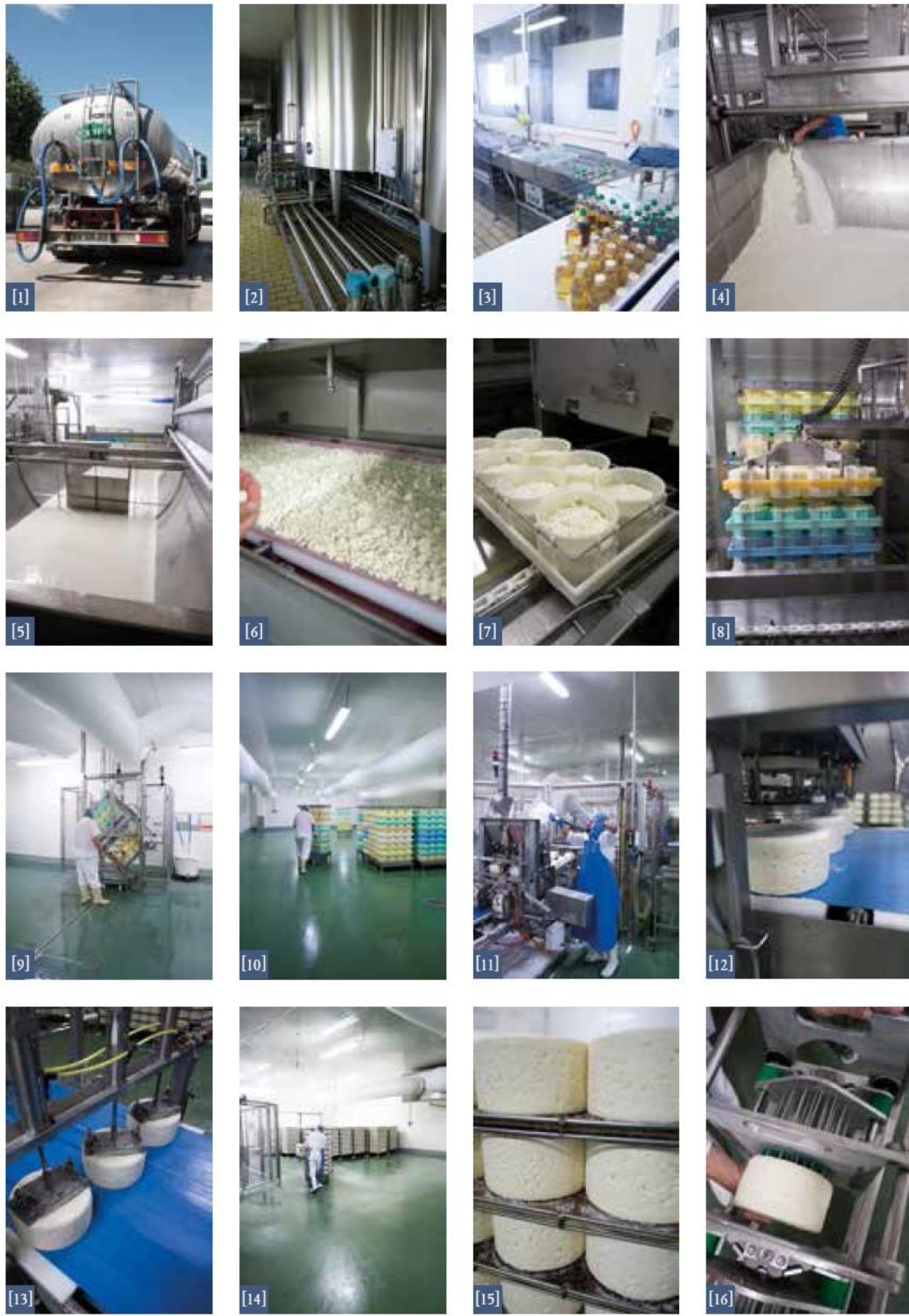
Figure 8 : Les étapes de fabrication du roquefort AOP telles qu'elles se déroulent à la Société Fromagère de Saint-Affrique (Anonyme, 2015) .
