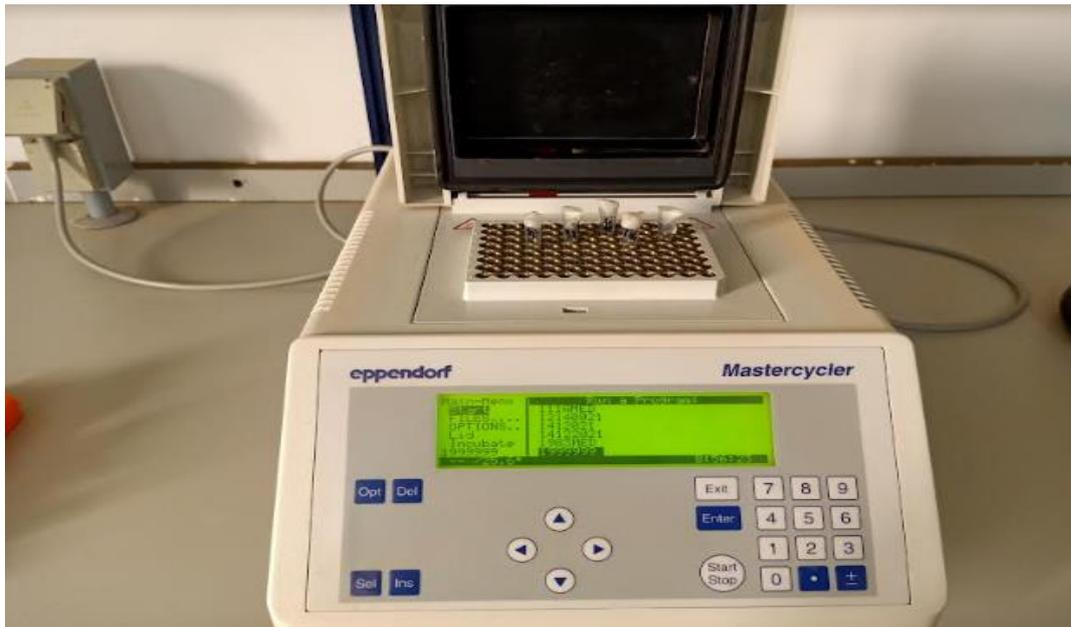
**Fig 16 :** l'appareil de la PCR (thermocycleur).(photo originale)
