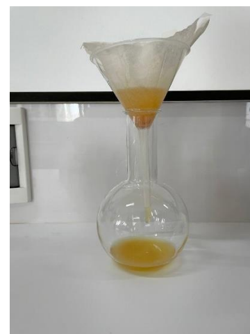
Figure 9 : Macération à froid et une filtration par papier joseph
