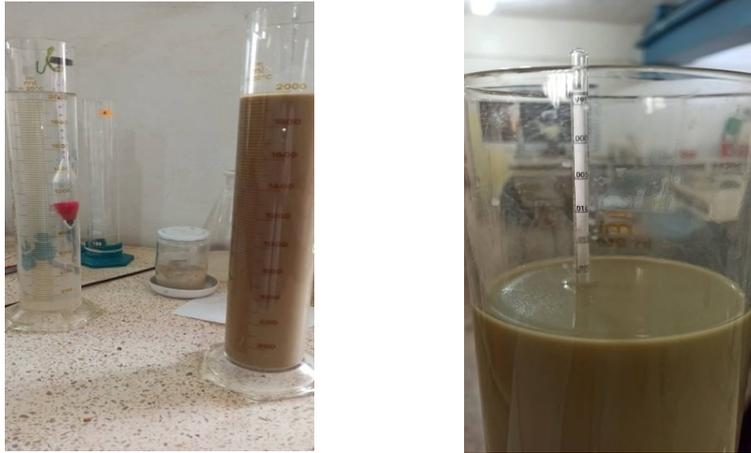
Figure 2-3 Analyse granulométrique par sédimentation
