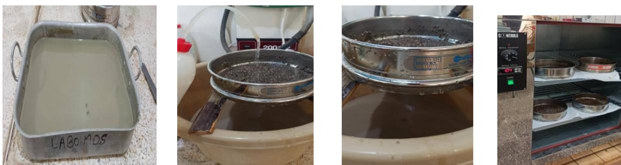
Figure 2-2 Analyse granulométrique par voie humide du matériau terre
