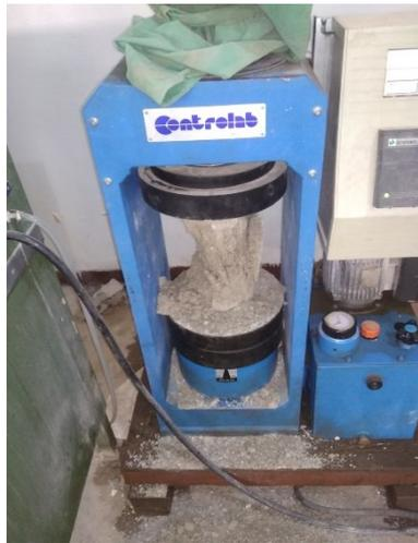
**Figure 3.6 Epreuve en béton de terre coulée à la rupture**
