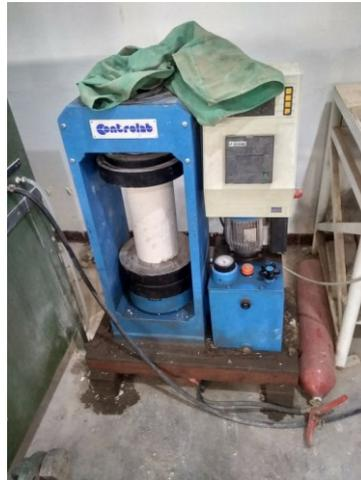
Figure 2-11 Illustration d'un essai de compression simple d'une éprouvette en béton de terre.
