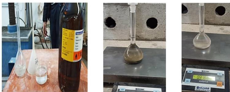
Figure 2-7 Détermination de la masse volumique des grains solides
