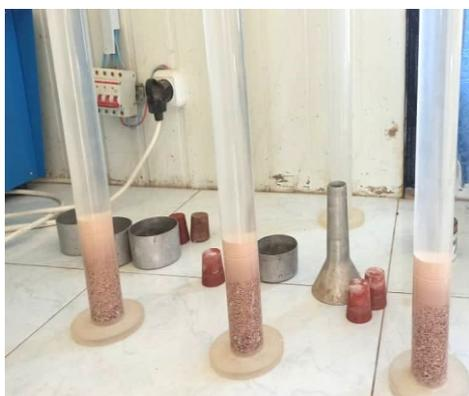
Figure 2-9 Essai d'équivalent du sable
