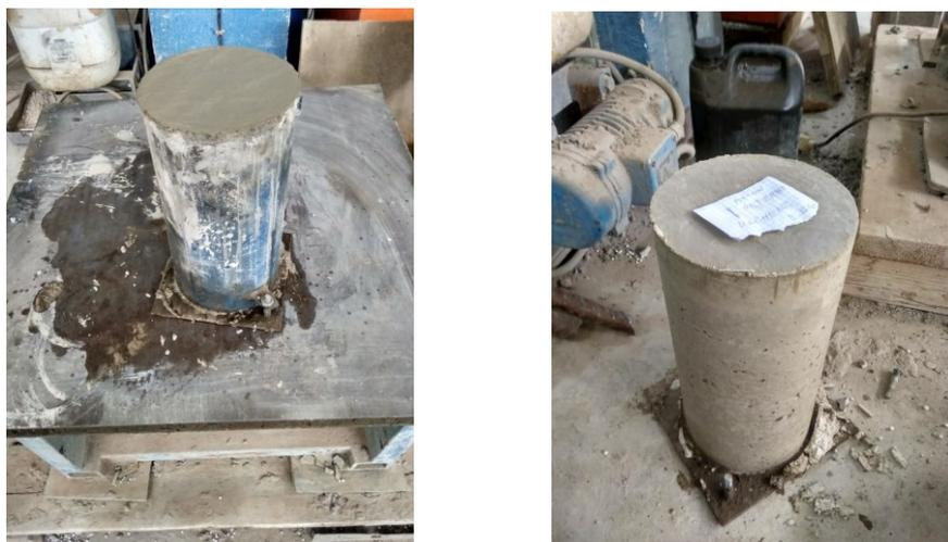
**Figure 2-10 Epreuve du béton en terre de 16×32 cm.**
