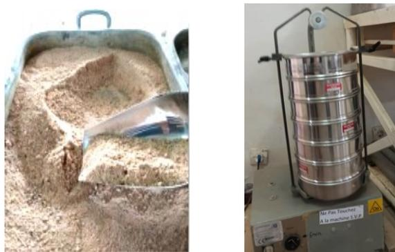
Figure 2-8 Analyse granulométrique du sable
