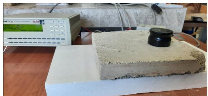
Figure 2-12 Appareil de mesure Quickline™ 30 utilisé pour l'essai thermique.
