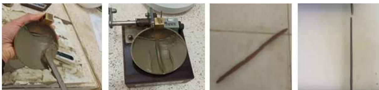
**Figure 2-5 Détermination de la limite de plasticité au rouleau**
