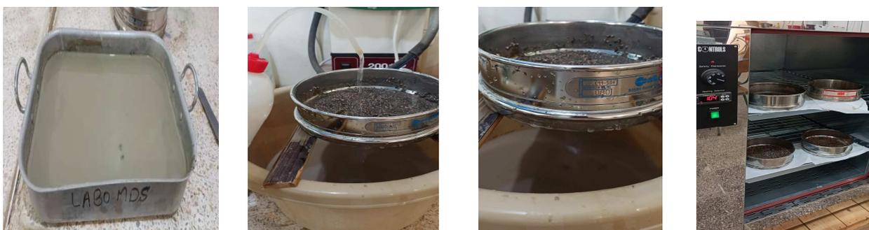
Figure 2-2 Analyse granulométrique par voie humide du matériau terre
