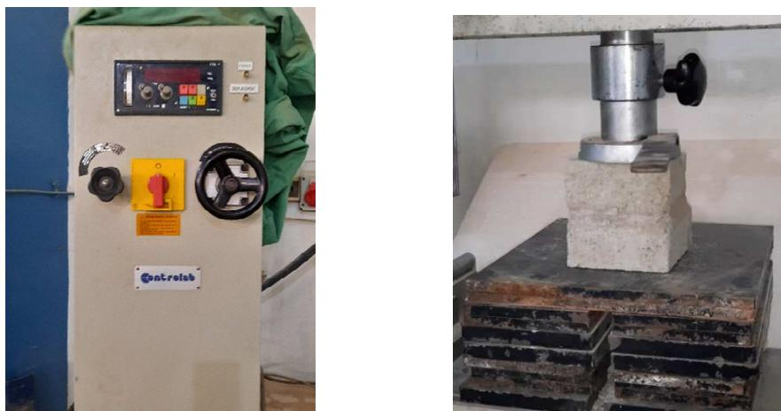
**Figure 2-14 Illustration d'un essai de compression simple d'une brique en terre comprimée.**
