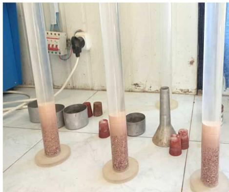
Figure 2-9 Essai d'équivalent du sable
