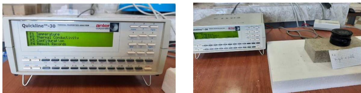
**Figure 2-15 Appareil de mesure Quickline TM 30 utilisé pour l'essai thermique.**
