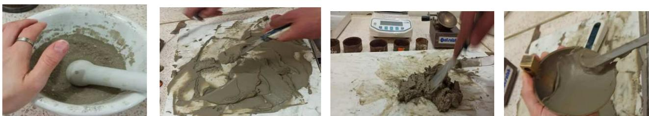
**Figure 2-4 Détermination de la limite de liquidité à la boîte de Casagrande**
