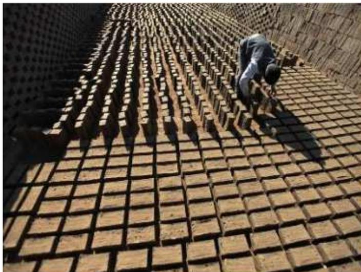
**Figure 1-7 Séchage des briques crue (7)**
