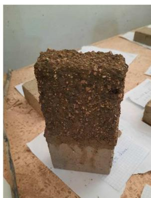
**Figure 3.5 Brique en terre comprimée à la fin de l'essai d'immersion**
