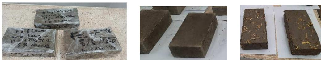
Figure 2-12 Éprouvettes de briques en terre comprimées.
