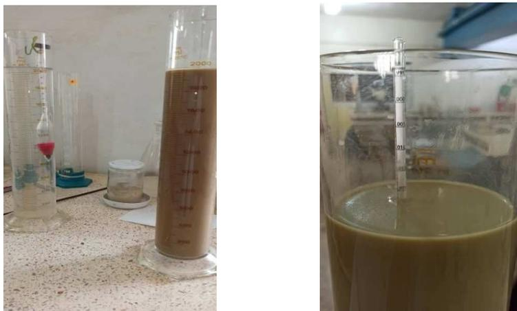
**Figure 2-3 Analyse granulométrique par sédimentation**
