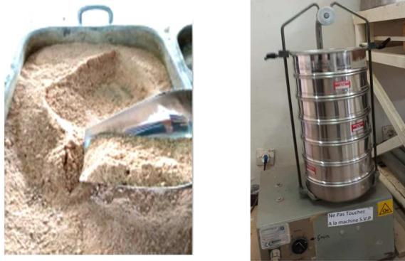
Figure 2-8 Analyse granulométrique du sable
