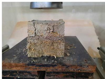
Brique en terre comprimée stabilisée avec 1% de paille
