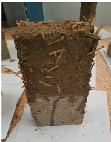
**Figure 3.6 Brique en terre comprimée stabilisée avec la paille**
