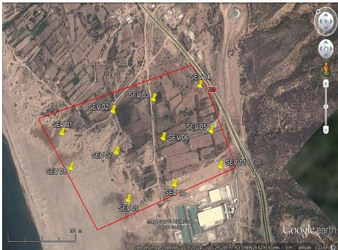
Figure III. 3: Le plan d'implantation des sondages électriques verticaux(GOOGLE EARTH)
