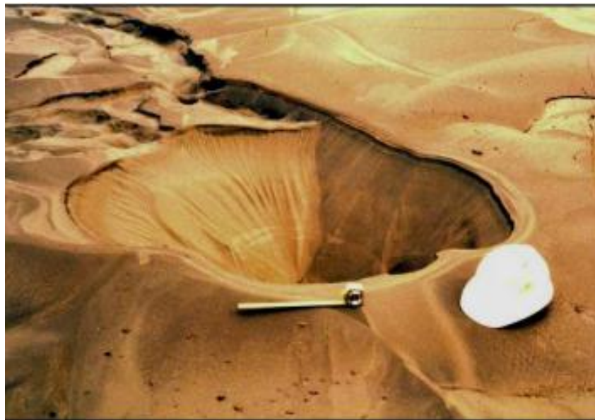
Figure 1. 7: Ebullition de sable à l'aéroport d'Oakland, le long du fleuve de Salina à la station marine de Moss Landing (D'après Robert E.Kayen et al,1995).
