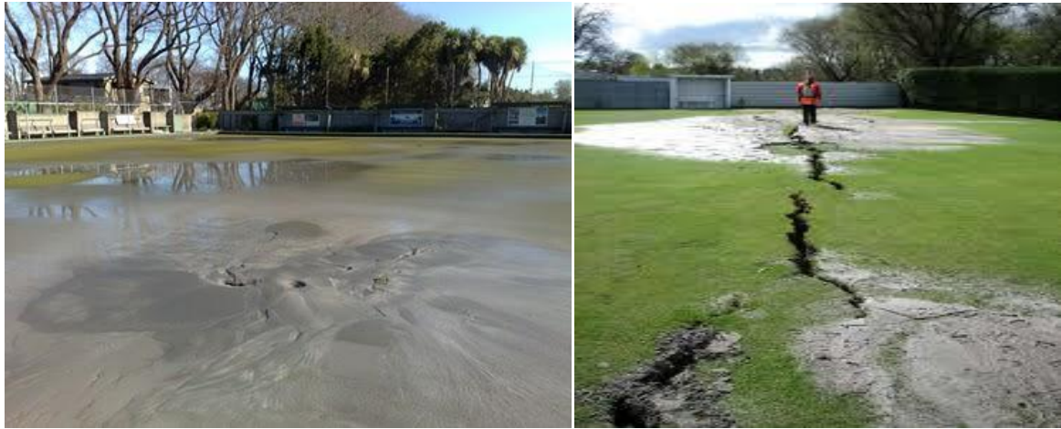
Figure 1. 20: Ebullition de sable dues à la liquéfaction, après le tremblement de terre à Christchurch, New Zealand(2011).
