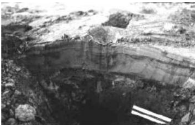
Figure 1. 5: Ebullition de sable au site de Wildlife (d'après le Earthquake Engineering ResearchCenter,University of California, Berkeley, Elgamal et al,2001)
