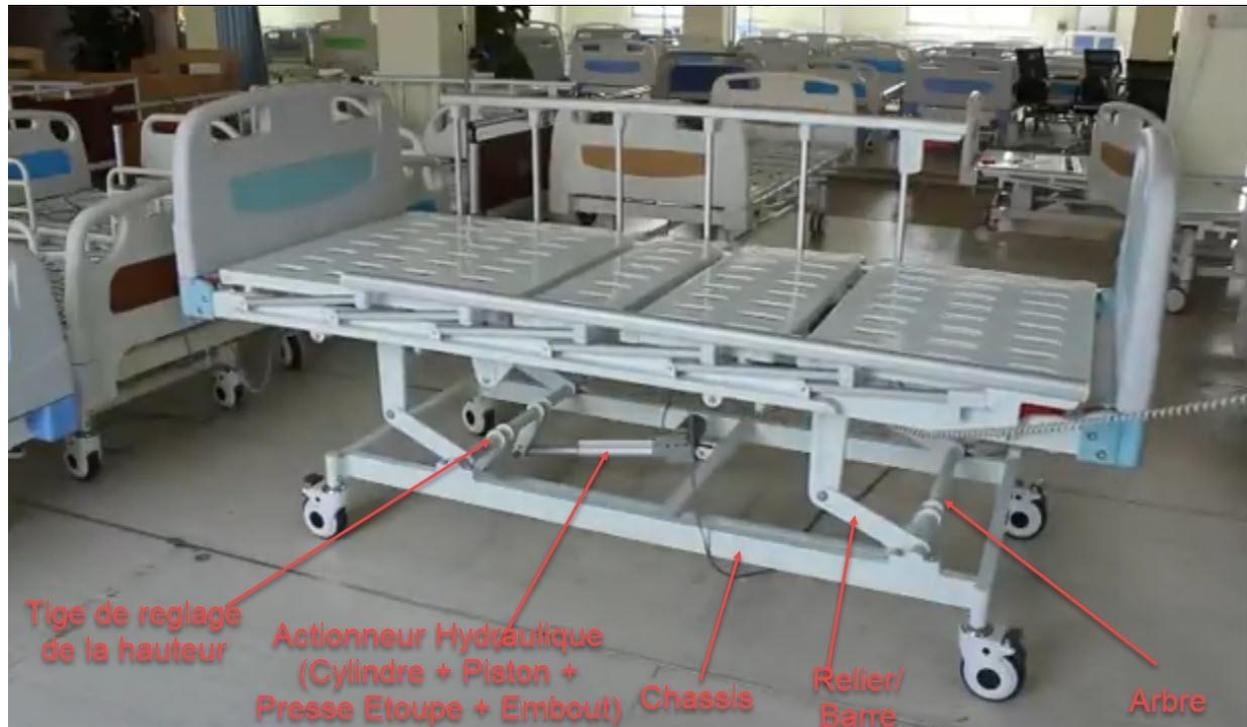
**Figure 3.7 :** Composants du système permettant la montée et descente d'un lit médicalisé éleveur.
