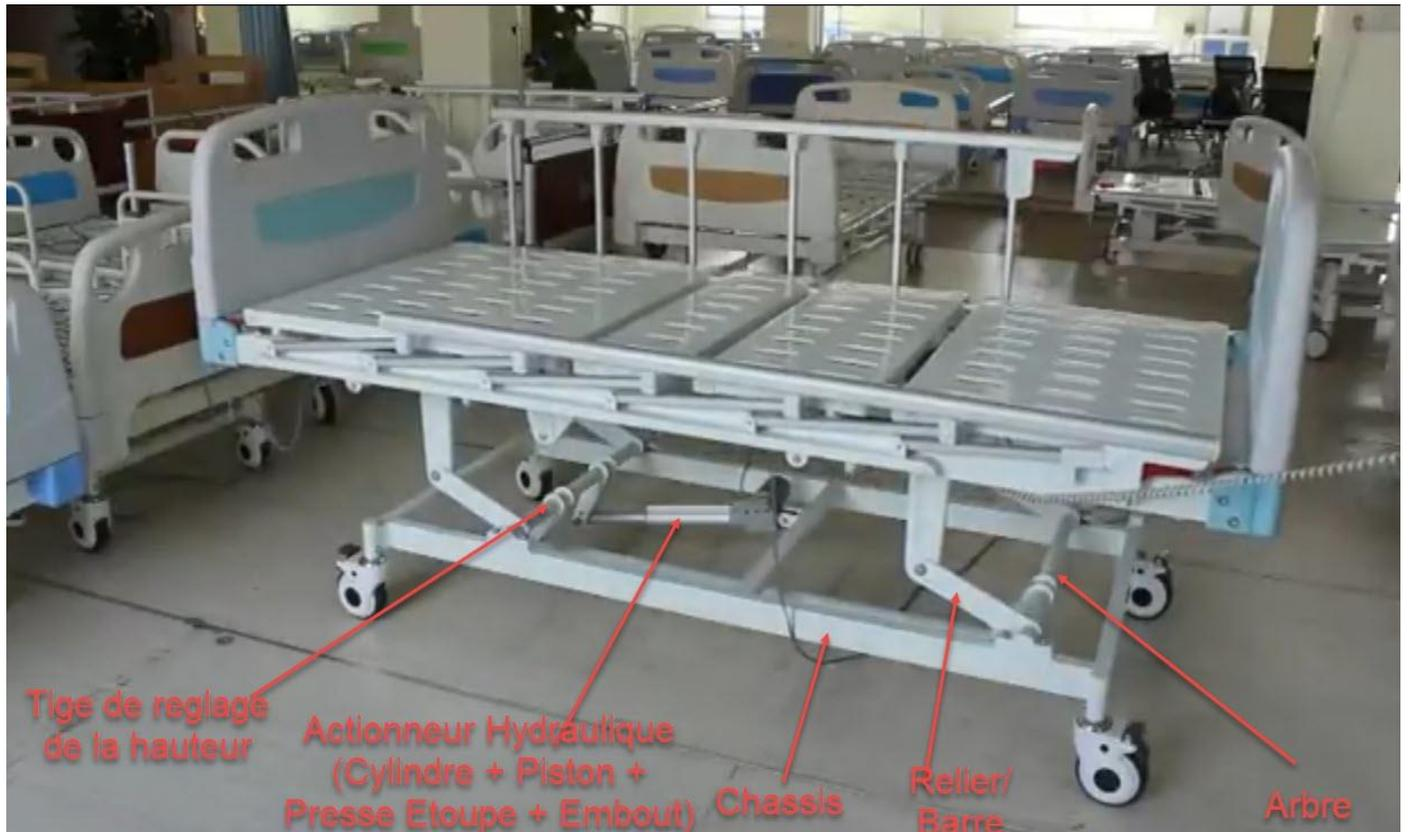
Figure 2.2 : Composants du système permettant la montée et descente d'un lit médicalisé élévateur.
