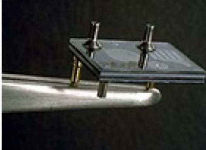
Figure I. 16 Pompe en silicium permettant la délivrance contrôlée de médicaments [3].
