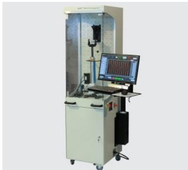
**Figure I-3** : Banc d'essais Endurance, Fatigue
