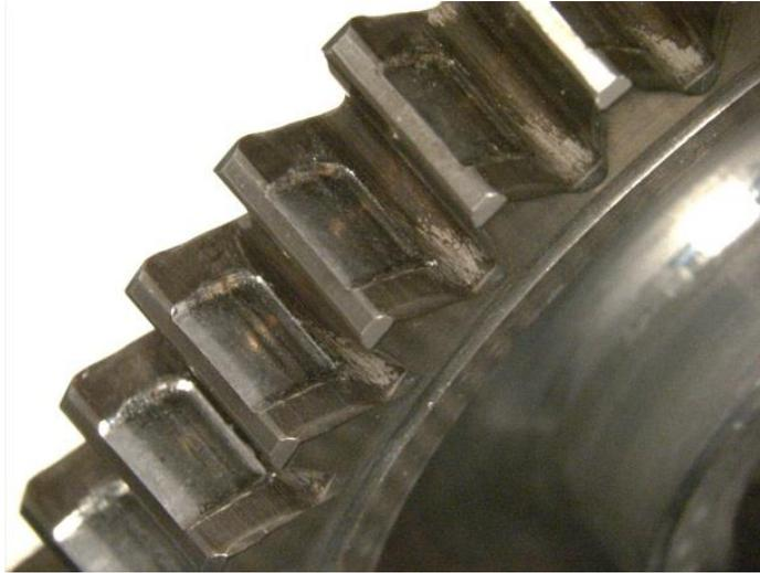
Figure II-10 : L'usure d'un engrenage
