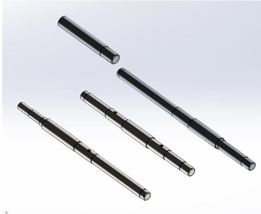
**Figure III-15:** Les arbres modélisés sur SolidWorks
