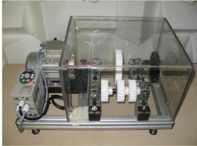
**Figure I-5 :** Banc d'essai d'analyse vibratoire et acoustique (INSA)
