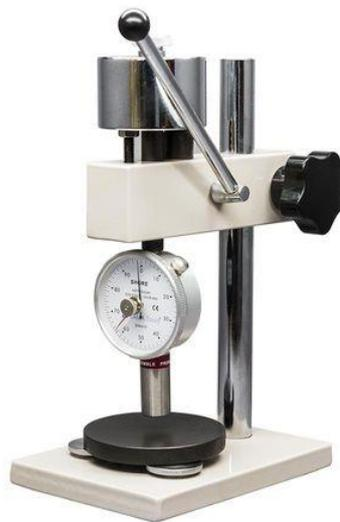
**Figure I-4 :** Banc de test de dureté
