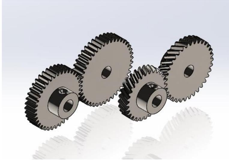
**Figure III-14 :** Les engrenages modélisée (engrange droit et engrange hélicoïdale) sur SolidWorks
