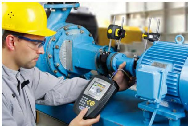
**Figure II-6 :** Systèmes d'alignement optique laser
