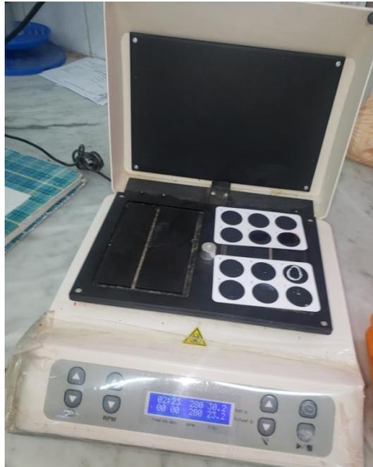
**Figure 14 : Agitateur pour le dosage de CRP**
