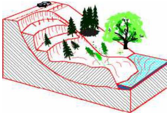
Figure 1.6 Glissement rotationnel complexe [4]
