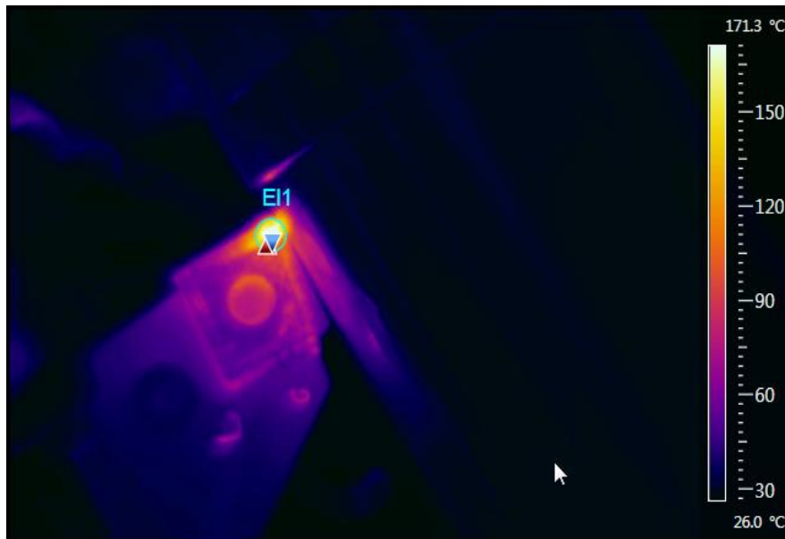
Figure V.27 : Thermogramme pour V_c = 112 m/min, a = 0.14 mm/tr et p = 1 mm.
