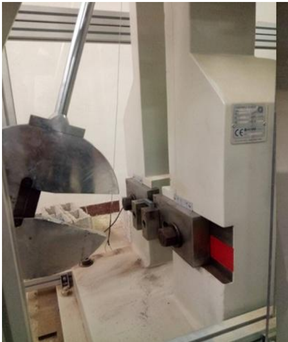
(a) : Machine universelle d'essai de Charpy. (b) : Montage utilisé (Ohmmètre (MT-1705))
