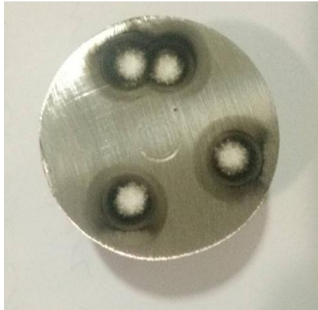
Figure IV. 6: Traces des étincelles sur l'échantillon.
