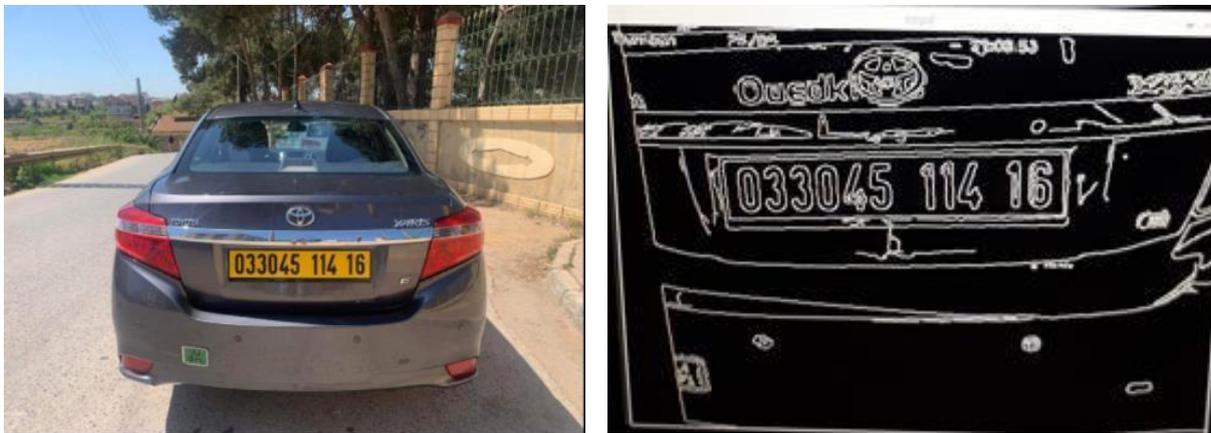
Figure III.3: Technique basée sur les contours de la plaque
